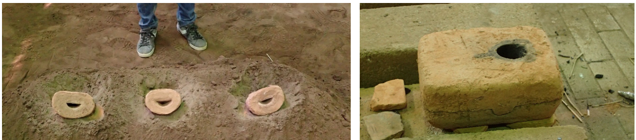
図2 復元製作品鑄造用の鑄型（左：直湯口 右：板堰）
