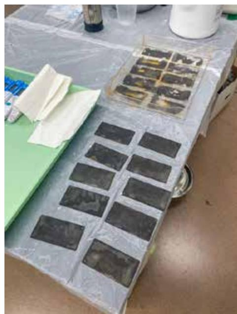
図2 防錆剤比較のための試験体
