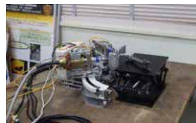
図 1 ポータブル X 線回折装置（DF-01）
